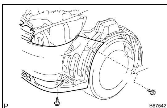
**23. INSTALL FRONT FENDER LINER LH**
